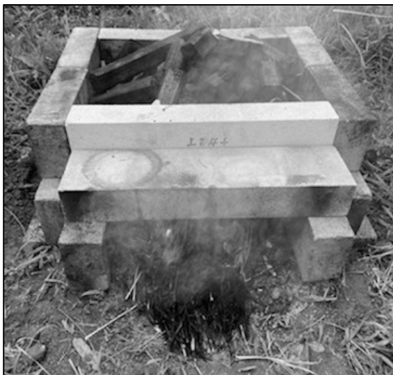
図7 焼成(図6の状態から薪の上に炭を敷き詰め、乾燥した藁を使い着火したところ。)
