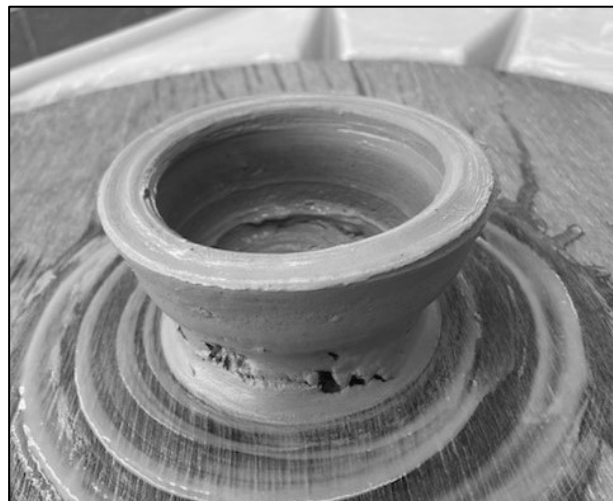
図4 ロクロ成形（②-B） 器の立ち上げ部分に横向きの大きな亀裂が入る。
