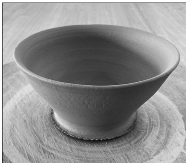
図5 ロクロ成形（①-B-ベントナイトあり） 同じ厚みできれいに成形できる。
