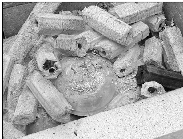
図8 焼成(炭を補充しながら焼成を行い、素焼きの温度程度に焼きあがったことを目視で確認したところ。)
